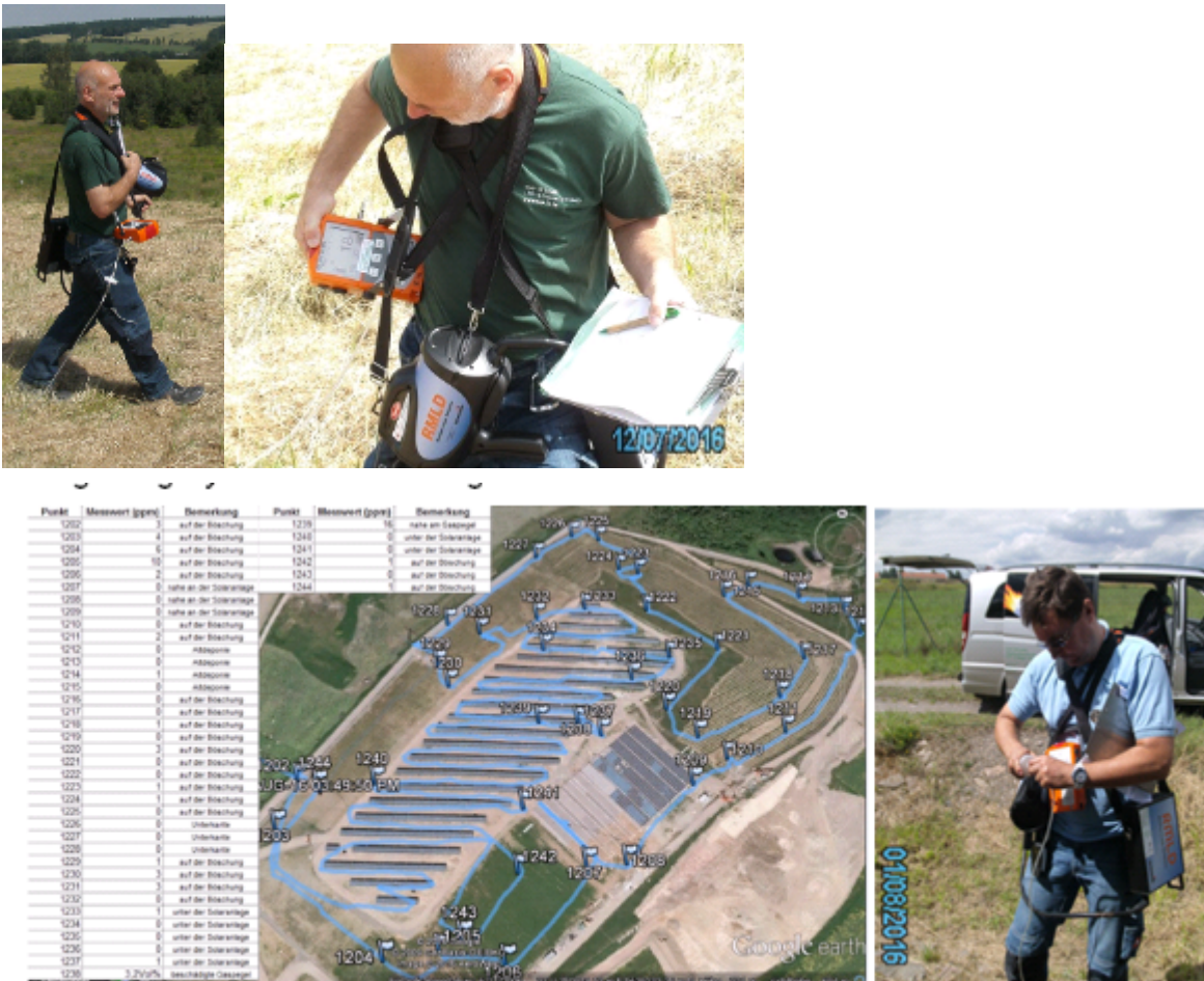
Abb. 17 GPS – Wegpunkte (Meßergebnisse mittels RMLD - Laser und HS 680) und GPS – Begehungsweg
